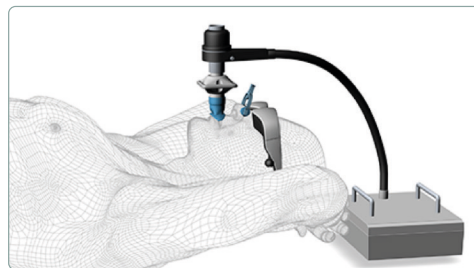
Principe du système de blocage de la respiration Un pince-nez évite les fuites nasales. Le spiromètre permet de mesurer le volume pulmonaire.
